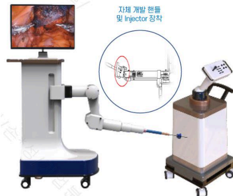
도표 2. 산부인과 복강경수술 및 약물 주입 어시스트 로봇 유봇(U-BOT)
